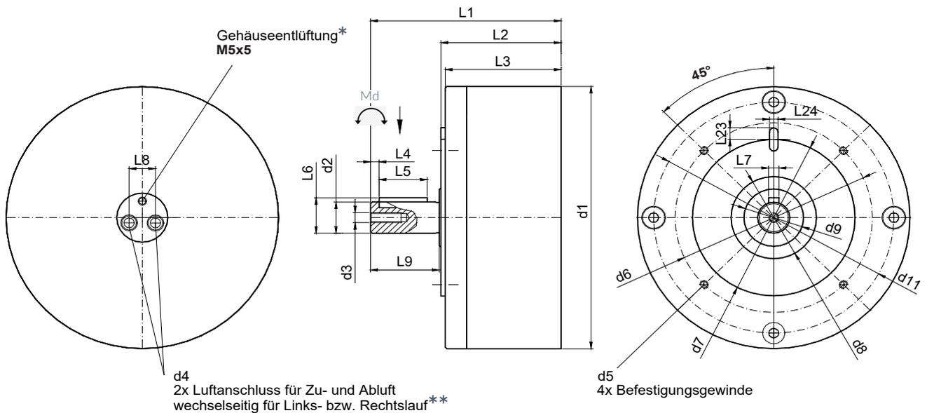
\*Die Gehäuseentlüftung muss frei und ohne Widerstand entweichen können. Bei Motoren, die in feuchten Umgebungen oder unter Wasser betrieben werden, muss die Abluft über einen Schlauch aus dem Feuchtbereich geleitet werden, so dass kein Wasser in das Gehäuse eindringen kann.
